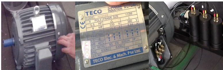
Gambar 8 Motor Induksi dan Kapasitor yang Dipakai Dalam Penelitian
